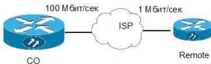
Пусть мы собираемся создать устойчиво работающие голосовые каналы через интернет между CO и Remote. Для простоты пусть сеть Remote (172.16.1.0/24) имеет только связь с CO (10.0.0.0/8). Скорость интерфейса на Remote - 1 Мбит/сек и 25% этой скорости выделяется на голосовой трафик.
